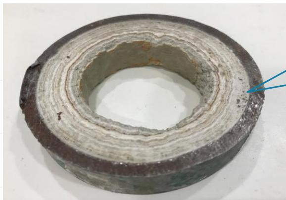
此照片是印尼某企業的水管切斷面、2年就生成11mm的水垢。
